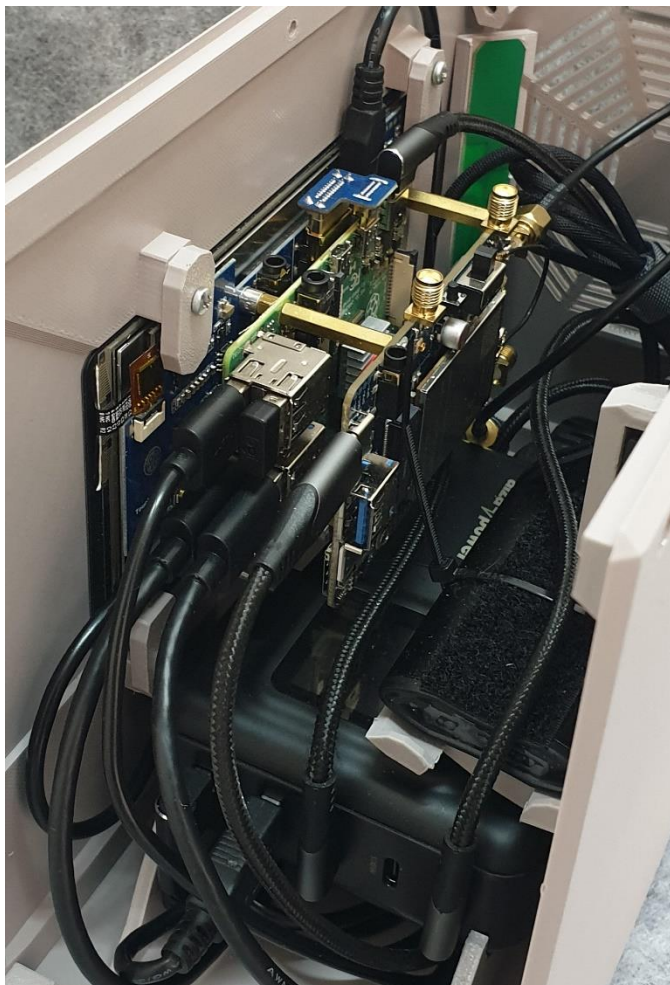
Obr. č. 9 - Provozní hardware - minipočítač Raspberry Pi 4, GNSS modul, 4G/5G modul, stabilizovaný zdroj napětí, displej, kabeláž, kamera
