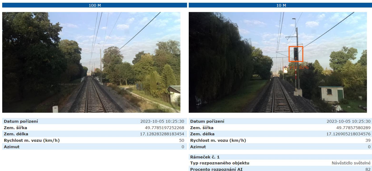
Obr. č. 7 - Detail návěstidla se snímky ze vzdálenosti 100 m a 10 m s AI detekcí
