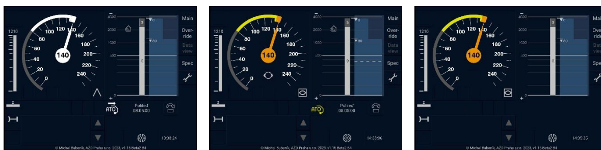
Obr. 3 - Porovnání zobrazení ERTMS/ETCS při dohledu cíle v provozním režimu AD (vlevo) vs. FS s C-DAS indikacemi (uprostřed) vs. FS bez C-DAS (vpravo)
