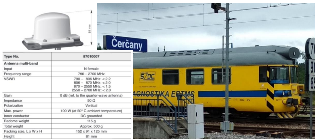
Obr. 1 - Motorový měřicí vůz ERTMS s použitými anténami
